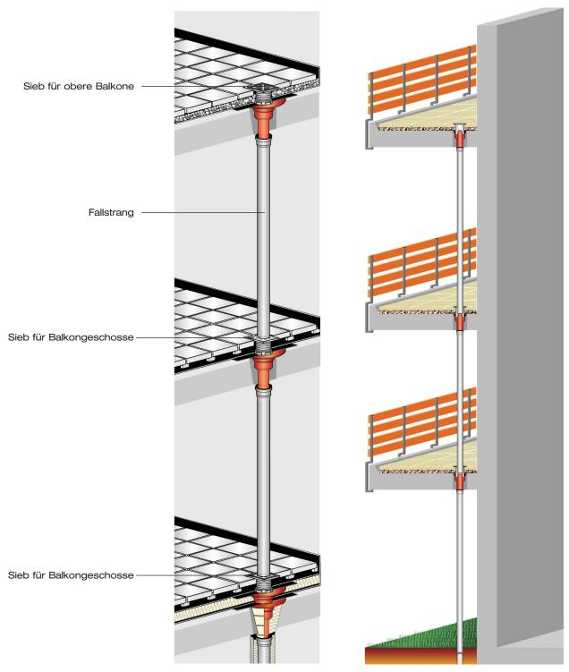
Balkonplatte mit Plattenbelag auf Plattenlagern mit Abdichtungsbahn, ohne/mit Wärmedämmung. Entwässerung in zwei Ebenen: auf der Abdichtung und oberhalb des Plattenbelages.
